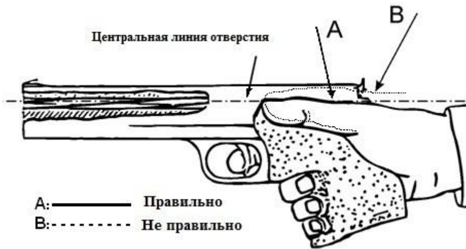
Рисунок 4. Положение большого пальца в рукоятке.
