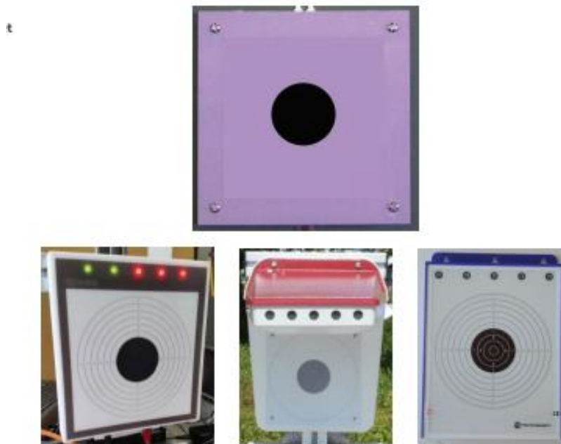
Рисунок 5. Лазерные мишени (попадание-промах / Hit-Miss).
